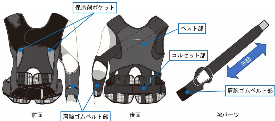
弊社の実験施設 R & Dセンターにおいて実施したアシスト効果の計測試験では、掘削動作の中で特に筋肉の負担(筋負担)がかかるとされる、すくった土砂の投げ出し動作において脊柱起立筋の筋負担を 10%程度軽減できるという結果が得られました。この数値計測には、筋線維から発生する微弱な電流を計測することで筋肉の使用程度を可視化できる筋電計及び、被験者の動作を 3次元で計測しパソコン上で動作解析を行う計測機器を用いました。
